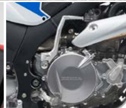
La palanca más corta, facilita el arranque subido en la moto
