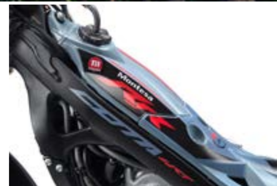
Nuevo depósito de aluminio: diseño y ligereza
